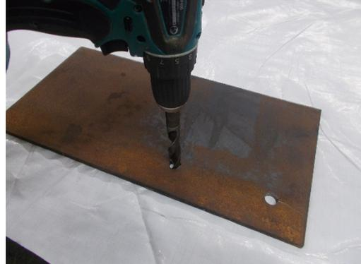
1.) Zwei Bohrlöcher von  $\varnothing$  14 mm rechtwinklig zur
