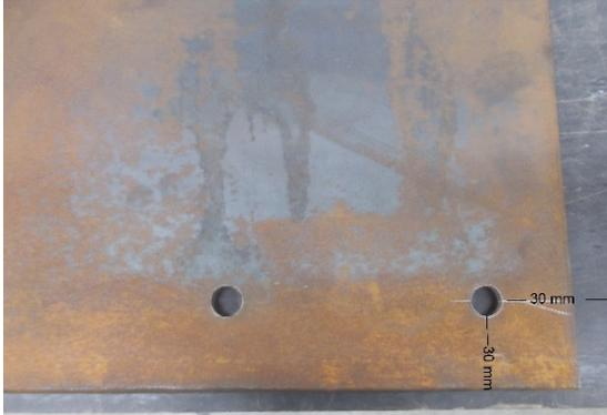
Randabstand von Bohrung zur Stahlkante
